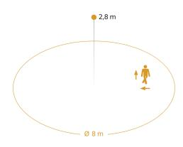
Hauteur d'instal lation: 2,00 m – 4,00 m Orange: sens de passage radial et tangentiel
